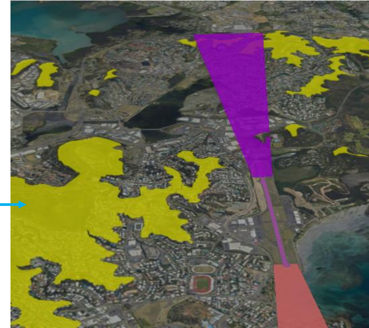
A partir du MNT + hauteur estimée, Création de surfaces flottantes (en jaune) pour la réglementation PSA
